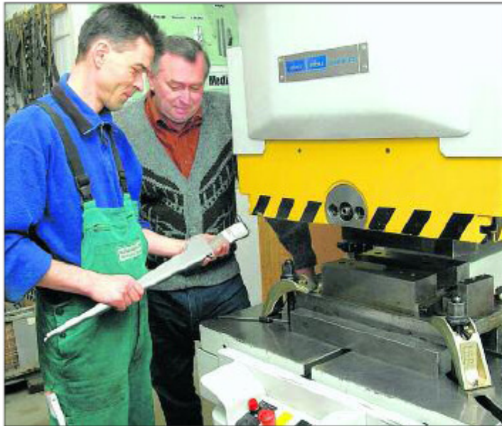
Einrichter Detlef Teumer (links) begutachtet mit Firmenchef Tobias Hänel ein Stanzteil, das gerade die 125-Tonnen-Exzenterpresse verlassen hat und bei einer Heizungsinstallation verwendet werden soll. – FOTO: WOLFGANG FREUND
